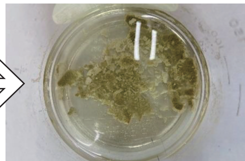
カルシウムは溶解し、シリカは剥離分解（約 2 時間）
