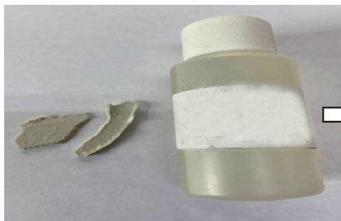
付着していた混合シリカ（スケール）
