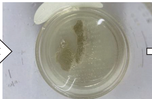
5 倍希釈の本製品に混合シリカスケールを浸漬
